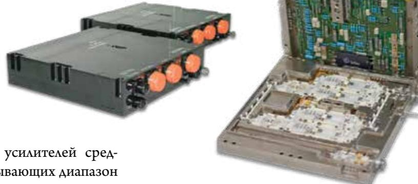
3. Серия универсальных усилителей средней мощности, перекрывающих диапазон 1-18 ГГц в герметичных микрокорпусах фланцевого типа.
