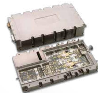
5. Мощные приемо-передающие модули, работающие в импульсном режиме, для применения в перспективных системах радиолокации.
