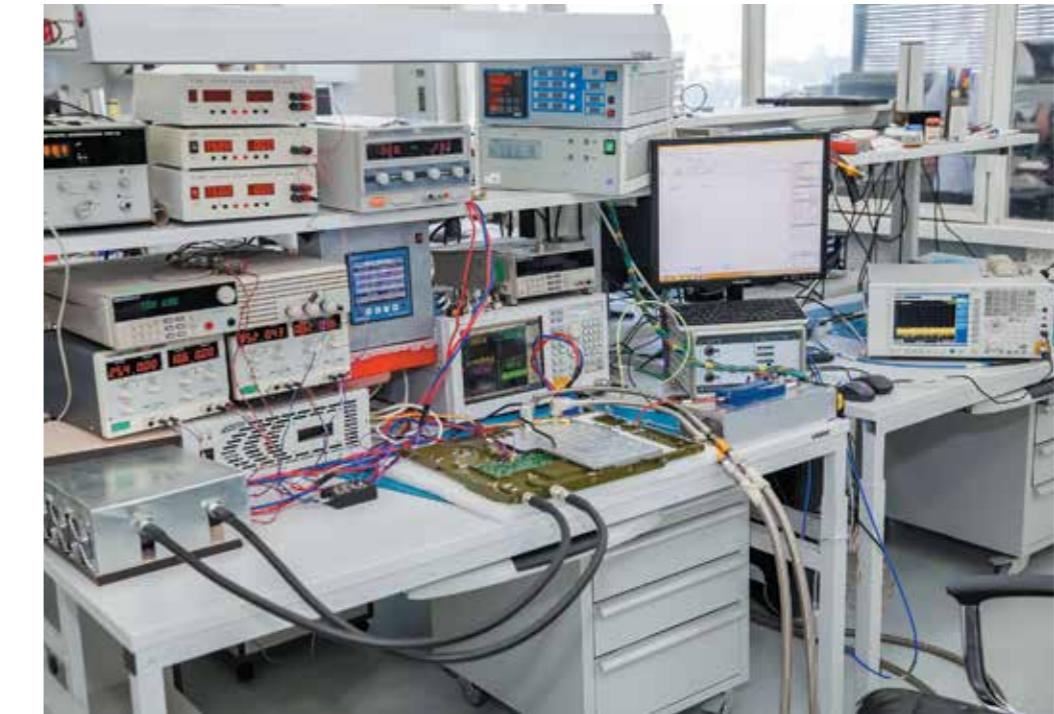
Автоматизированный стенд комплексной настройки мощного усилителя СВЧ с жидкостным охлаждением.
