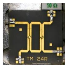
Рисунок 2. Конструкция тандемного сумматора мощности.
