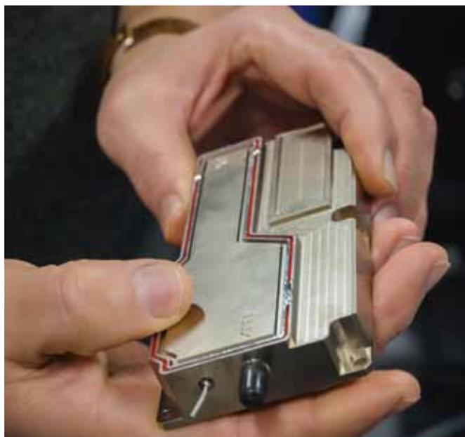
Модуль с установленной крышкой. По контуру крышки виден фторопластовый уплотнитель
