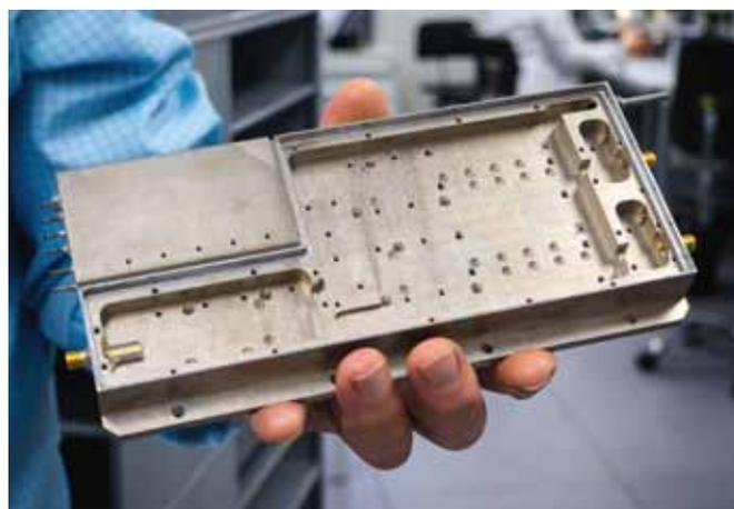
Корпус СВЧ-модуля. В правом верхнем углу видна трубка для откачки воздуха и заполнения азотом герметичной части
