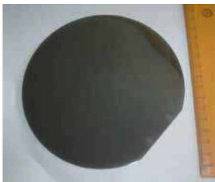
Рис. 1. Пластина нано-SiC/Si диаметром 150 мм, полученная методом согласованного замещения атомов
