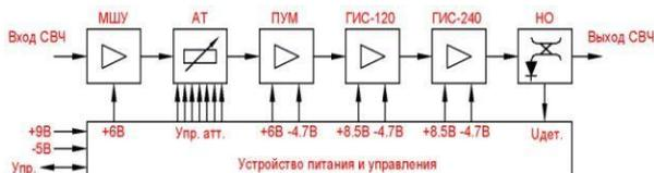
Рисунок 5. Структурная схема усилителя
