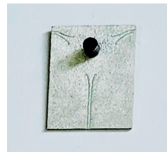
Рис. 9. Ферритовые изделия, изготовленные по технологии LTCC
