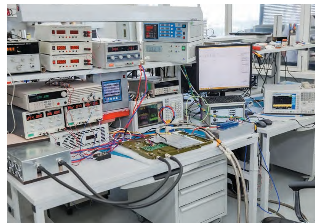
Автоматизированный стенд комплексной настройки мощного усилителя СВЧ с жидкостным охлаждением.
