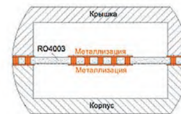
Рисунок 3. Разрез конструкции линии передачи мощного СВЧ сигнала
